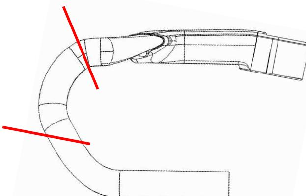
Klemmen Sie die Spacer (1 Spacer pro Seite) zwischen Bremsleitung und Cockpit ein und fixieren ihn mit Klebeband. Anschließend kann wie gewohnt das Lenkerband gewickelt werden.
